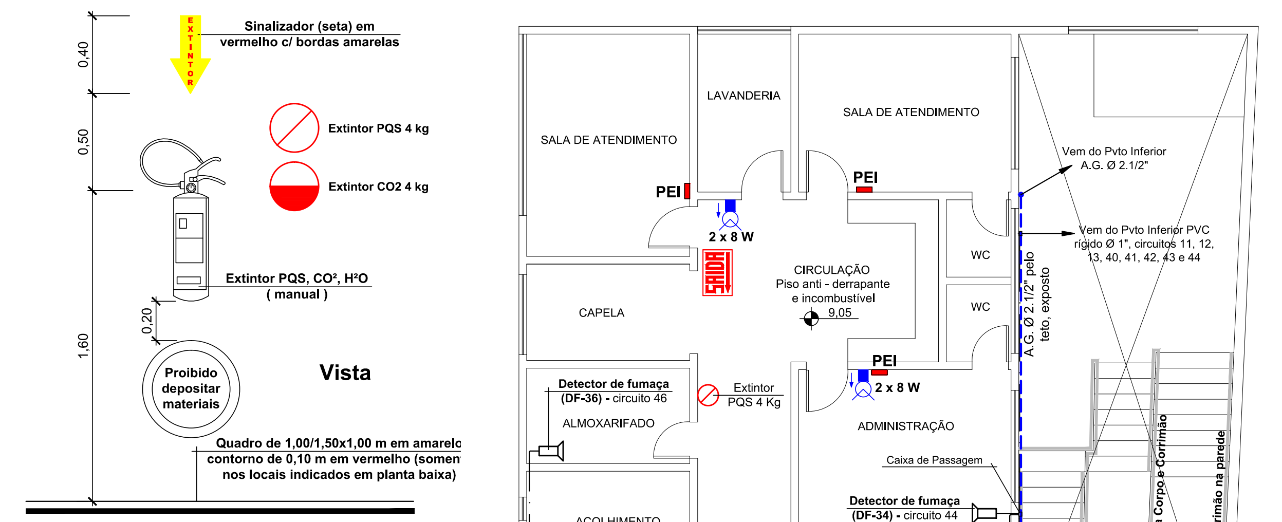
Detalhe do Extintor Escala 1:20
