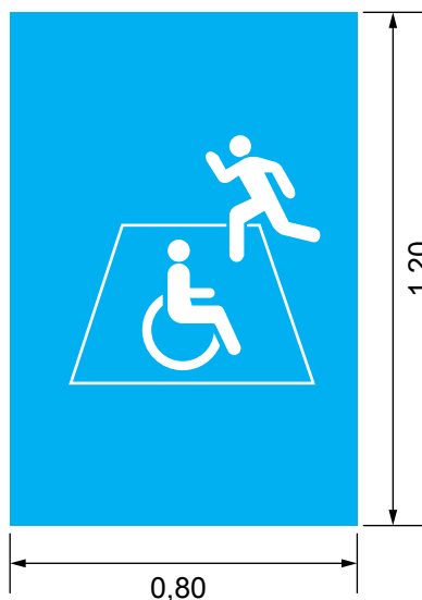
Figura 64 – Área de resgate para pessoa com deficiência
